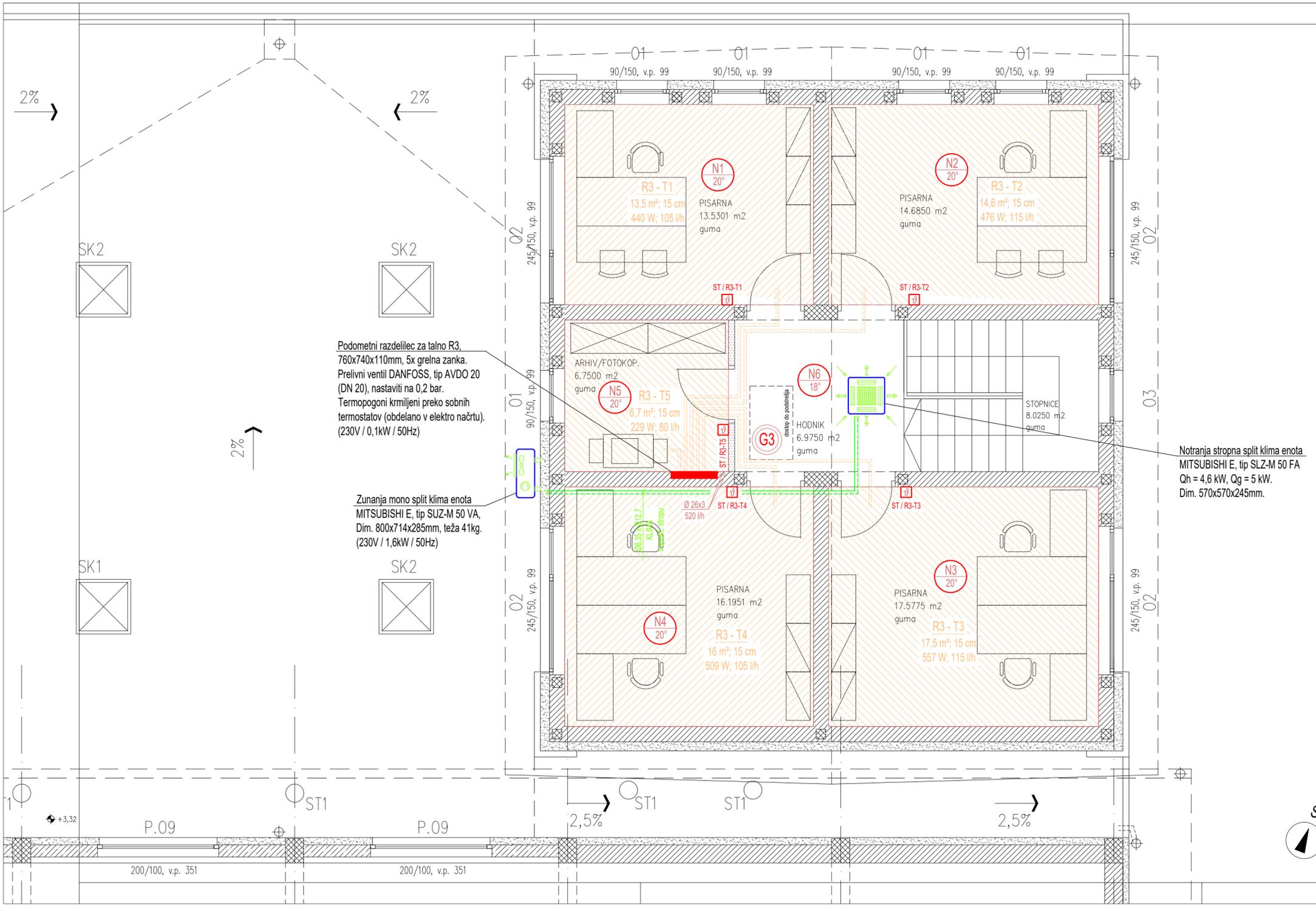
Podometni razdelilec za talno R3, 760x740x110mm, 5x grelna zanka. Prelivni ventil DANFOSS, tip AVDO 20 (DN 20), nastavitvi na 0,2 bar. Termopogoni krmiljeni preko sobnih termostatov (obdelano v elektro načrtu). (230V / 0,1kW / 50Hz)
