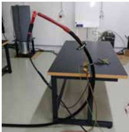
■ Preizkus plašča in napetostni preizkus 20 kV enožilnega XLPE kabla
