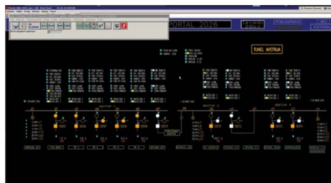
ZASLONSKI PRIKAZ ENOPOLNE SHME POSTAJE BS4 V SCADI*
