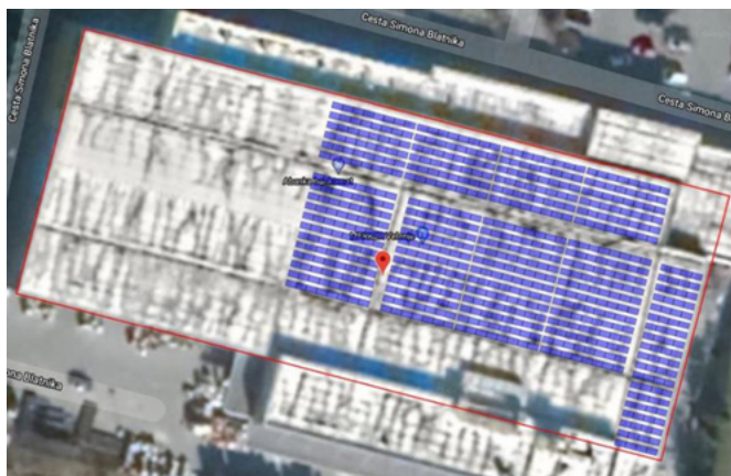
Postavitev modulov sončne elektrarne Merkur Velenje. Vse Merkurjeve sončne elektrarne bodo imele vgrajene fotonapetostne module moči 455 W, SolarEdge razsmernike in optimizatorje. Priključene bodo na interno inštalacijo za obstoječim merilnim mestom.
