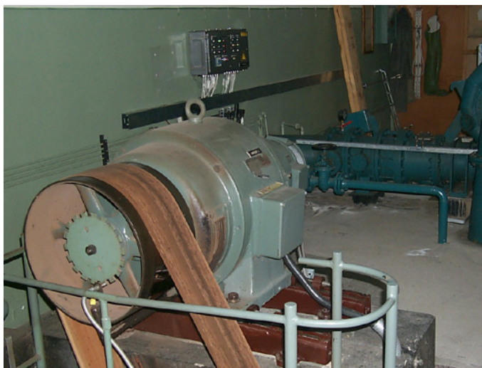
Dvojna Peltonova turbina, ki je nadomestila stara agregata, bo zagotavljala višji izkoristek na celotnem obratovalnem območju.
