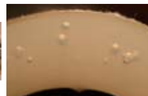
Slika 4: Primer zračnih mehurčkov v izolaciji 20 kV XLPE kabla – TP Hotel Jelovica (EG), Viljem Bonča
