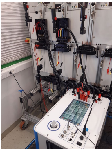
Kontrola točnosti prenosne naprave v laboratoriju
