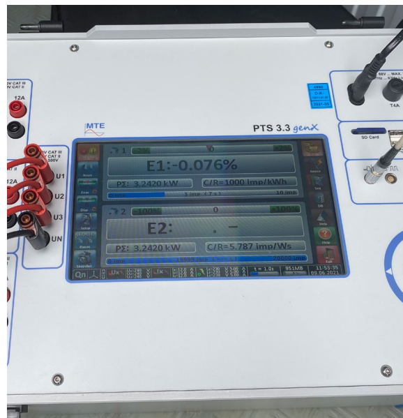
Prikaz pogreška števca na zaslonu prenosne naprave
