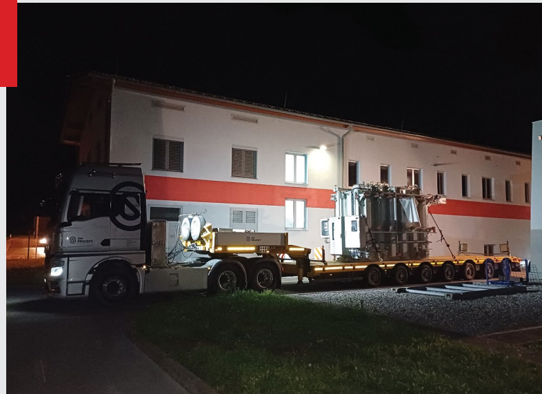
PREVOZ TRANSFORMATORJA V RTP ŽELEZNIKI Foto: Simon Đukić
