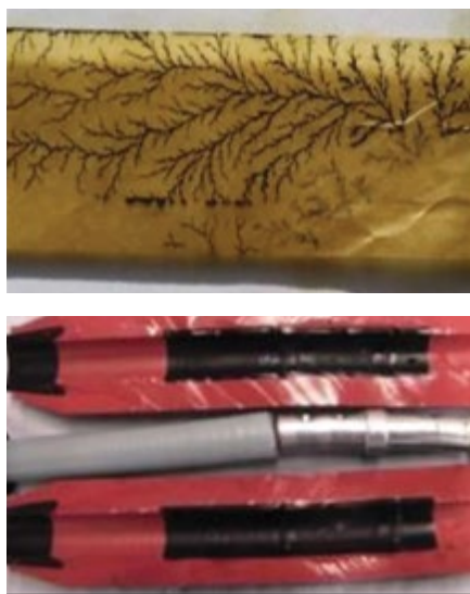
SLIKA 3: POSLEDICE DELOVANJA DELNIH RAZELEKTRITEV [MEGGER]
