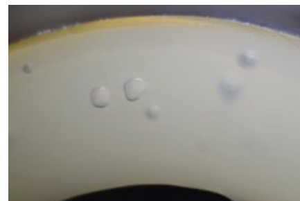
SLIKA 2: ZRAČNI MEHURČKI V KABSKE IZOLACIJI [MEGP PLUS, D. O. O.]
