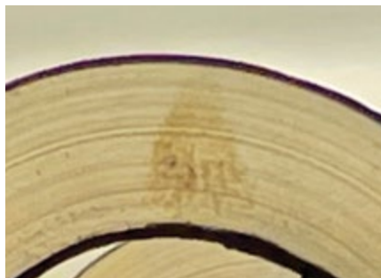
SLIKA 1: K0227 KN RADOVLJICA PREBOJ ELEKTRIČNEGA DREVEŠA [MEGP PLUS, D. O. O.]
