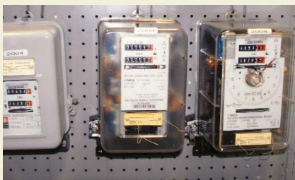
Klasični indukcijski števeci za merjenje električne energije v skladišču števec, 2004 (foto Drago Papler)
