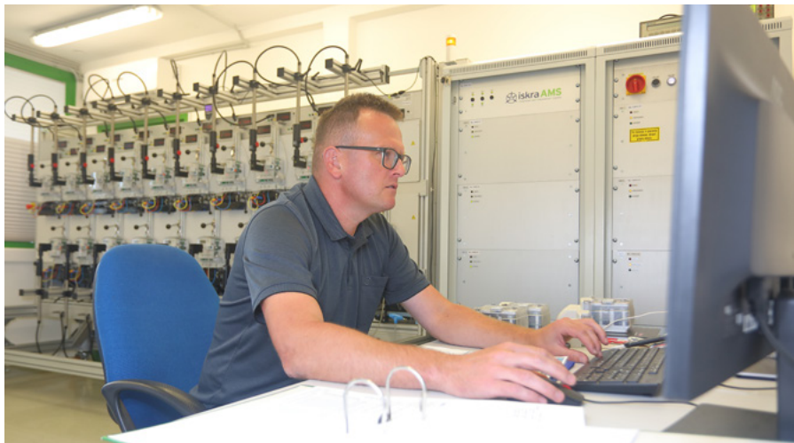
Jure Ferlic pri izvajanju kontrole in overitve števecv električne energije
