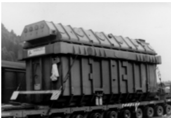
Najtežji mrežni transformator v Jugoslaviji 400/110 kV moči 300 MVA je bil 20. julija 1984 prepeljan na Okroglo – Foto: Drago Papler
