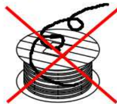
Slika 5: Primer transporta kabla
